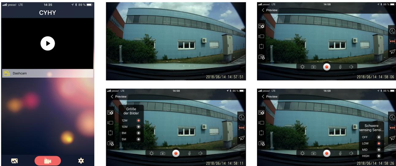
Berühren Sie den Bildschirm um Einstellungen wie Foto- und Videoformat zu ändern, die Länge der Videoaufnahmen festzulegen (OFF bedeutet, dass das Video nicht geschnitten wird) sowie um Fotos der aktuellen Kameraansicht zu machen.
